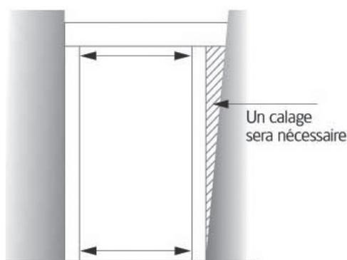
Les coulisses doivent être fixées de façon parfaitement parallèle sur la hauteur et parfaitement alignées sur la largeur. Si ce n'est pas le cas, un calage est nécessaire.
