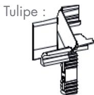
Paire de tulipes injectées en polyacétal (C). Elles assurent le guidage des lames à « l'entrée » des coulisses pour éviter une usure prématurée des lames à la descente du tablier.
